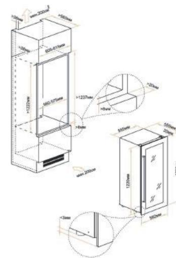
\*Схема встройки в колонну.
