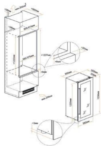
\*Схема встройки в колонну.
