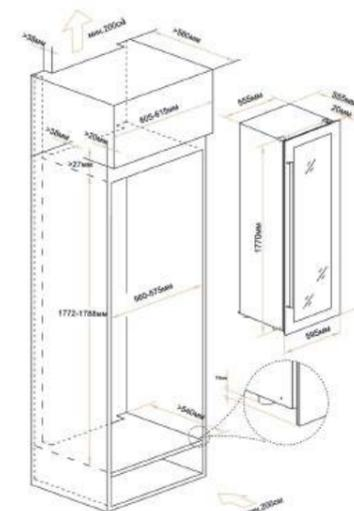
\*Схема встройки в колонну.
